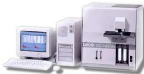
Figura 7: Equipamentos utilizado para determinação de carbono por combustão seca com equipamento LECO, modelo C-144 com computador acoplado ao LECO.
