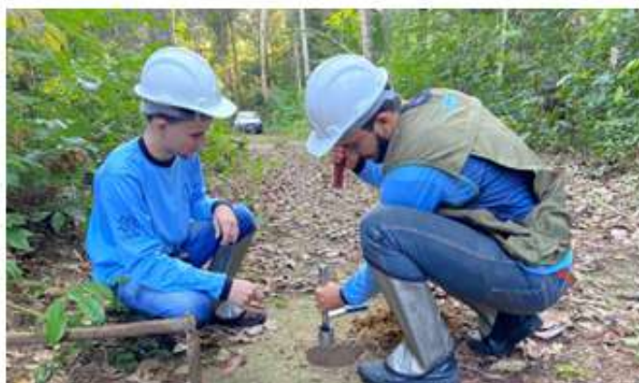
Figura 10: Esquema de coleta de solo para determinação da densidade.
